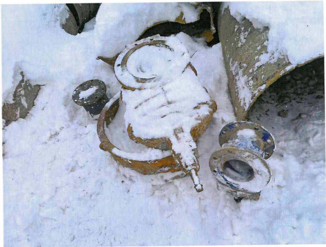
Фото №39. Элементы запорной арматуры.
